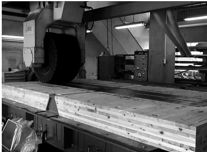
写真3 輪荷重走行試験(山口大学工学部)
