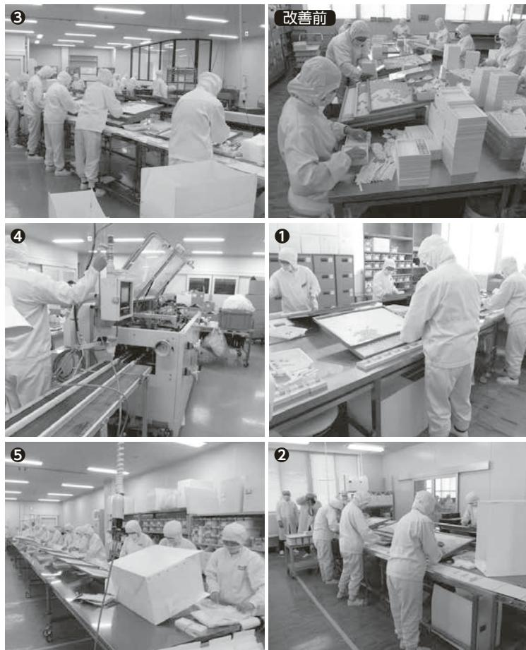
①立ち流れ作業での箱詰めに変更。この時点では手送り ②ベルトコンベアを導入した流れ作業に変えタクトタイムを安定化 ③コンベアを延長し作業者を増員。また、商品別にラインを使い分け ④箱詰め工程と包装工程の同期化 ⑤包装機と同期した箱詰めラインの完成で生産性が1.5倍以上向上した
