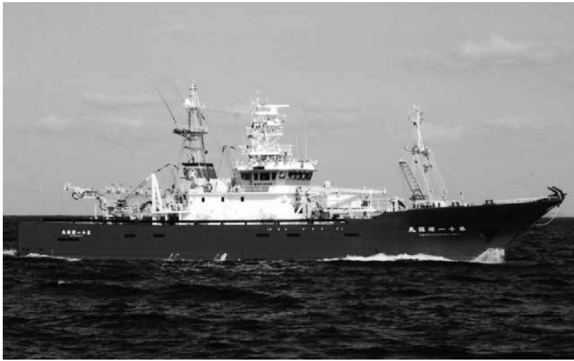
199トン二層甲板型まき網漁船(『海洋水産エンジニアリング』2015年1月号より)
