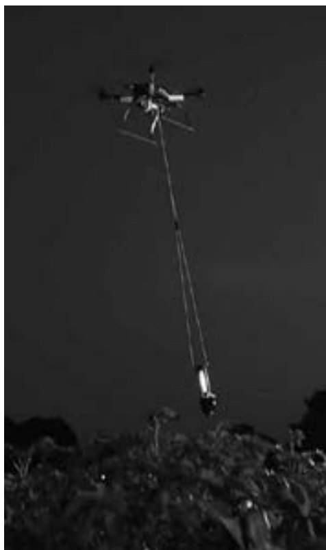
誘蛾灯をつり下げて 畑の上を飛行する ドローン
