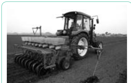
播種適期に不耕起播種機で高能率作業 (写真は試作機)
