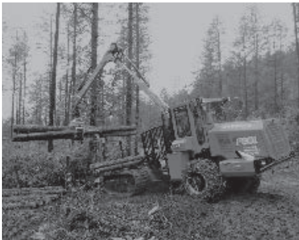
大型フォワーダで原木を積む。千歳林業ではこうした高性能林業機械を多数導入し、広大な山林を効率よく管理している
