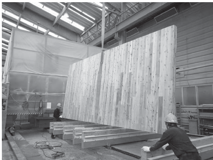
日本でつくられたスギ材によるCLT (2.7m×6m)
