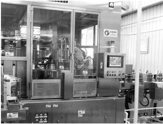
クリーンルーム化されている全自動充填システム装置。1時間に2,000本を製造する
