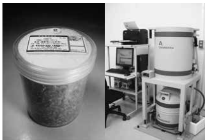
放射性セシウム測定用の認証標準物質とゲルマニウム半導体検出器
