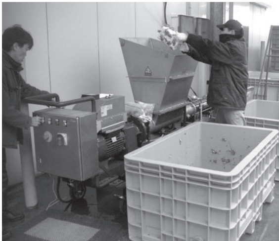
写真2: 干し芋残さを一次処理として粉碎し、乳酸菌添加後、コンテナに密封する
