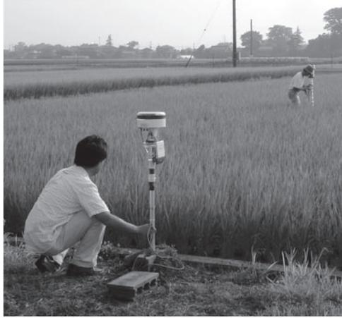
複数のフィールドサーバによりセンサネットワークが構築される
