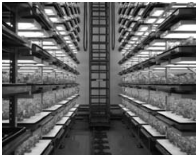
写真3：自動搬送装置を備えた植物工場
