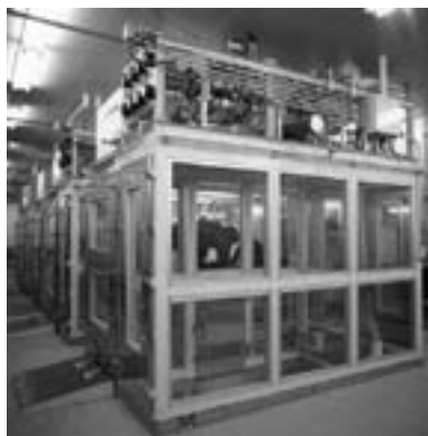
大家畜用呼吸試験装置 ウシの酸素消費量や炭酸ガス、メタンの発生量を測定する装置。わが国の家畜由来メタン発生量の推定式はこの装置で得たデータをもとに作成されました。
