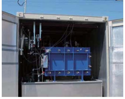
社外での実験に使うレドックスフロー蓄電池。
