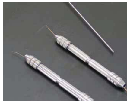
左2本が極細のレーザー溶接棒、右上が TIG 溶接棒。
