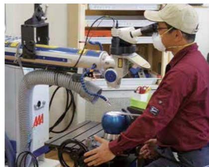
レーザー光を集光して溶接。顕微鏡を見ながらの作業。
