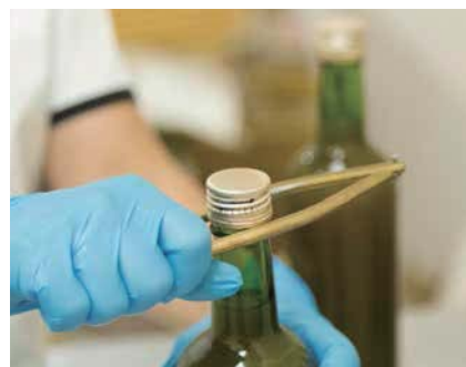
スクリューキャップを密封する自社開発のカンメ器。
