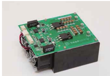
次世代パワー半導体 SiC を搭載した回路ブロック。
