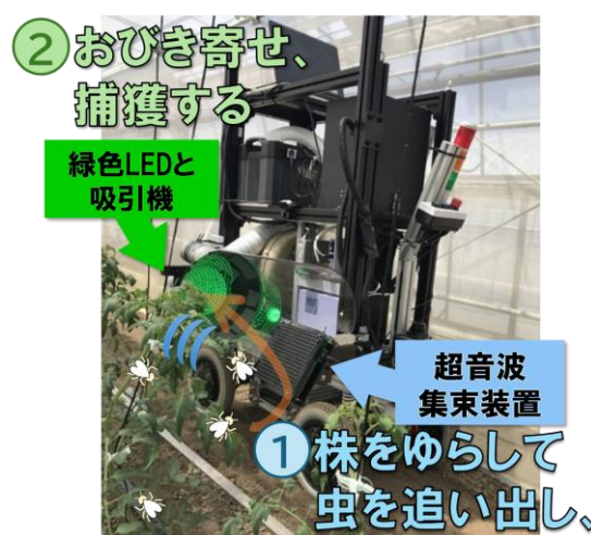
図 1 共同開発したコナジラミ類を対象とする害虫防除ロボット
