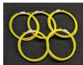
図 2 日 137 号×MC502 の繭糸で試作した三味線用絹絁
