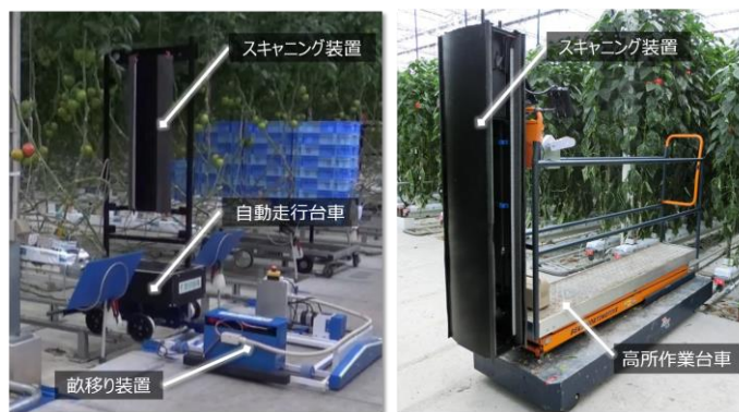
図1 トマト果実用装置（左）とパプリカ果実用装置（右）
