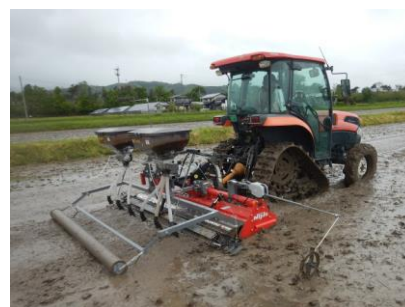
図3 代かき同時浅層土中播種作業
