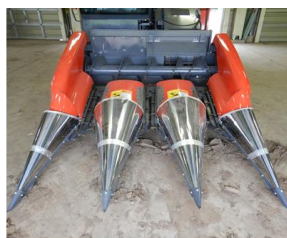
図2 国産汎用コンバインに装着可能なスナッパヘッド
