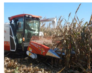
図2 国産汎用コンバインに装着可能なスナッパヘッド
