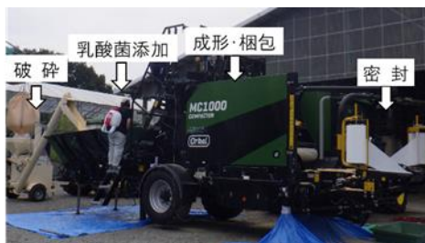
図1 サイレージ調製の様子 (左: 破砕機、 右: マルチコンパクター)
