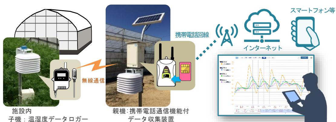
図 市販の ICT 環境計測機器を用いた気温遠隔測定システムの構成例
