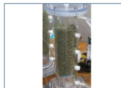
写真3 大谷石を充填した脱臭リアクター
