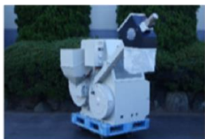
図1 改良した脱皮破碎機
