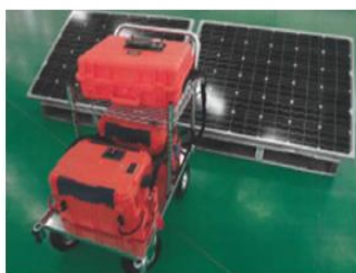
写真1 太陽光移動蓄電装置
