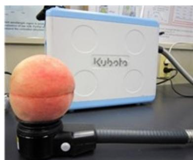
図1 非破壊糖度計(フルーツセレクトター、クボタ)によるモモ果実測定の様子
