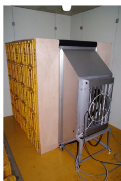
写真1 プレハブ冷蔵庫内の小型防除装置
