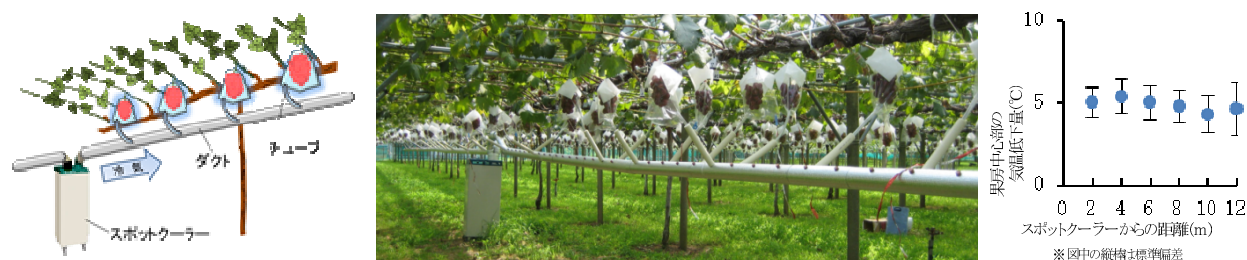
図1 スポットクーラーを利用した果房冷却装置(左:模式図、中:設置の様子、右:距離と気温低下量)
