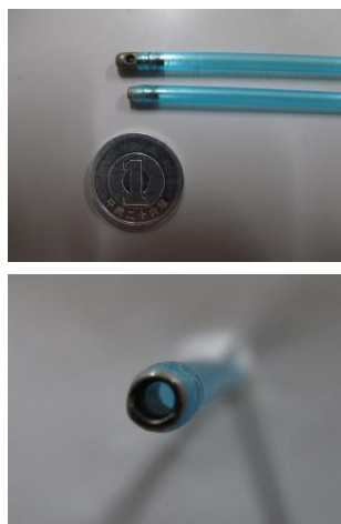
図1 シース管の先端をカットして改良した移植器（左上、左下）、□ 1カ所のみカテーテルの穴を大きくし、その他の穴は塞いで□ 採胚用バルーンカテーテルを改良した移植器（右上、右下）□□
