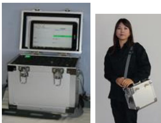
図1 携帯型貧血測定装置 装置一式(左)と携帯例(右)
