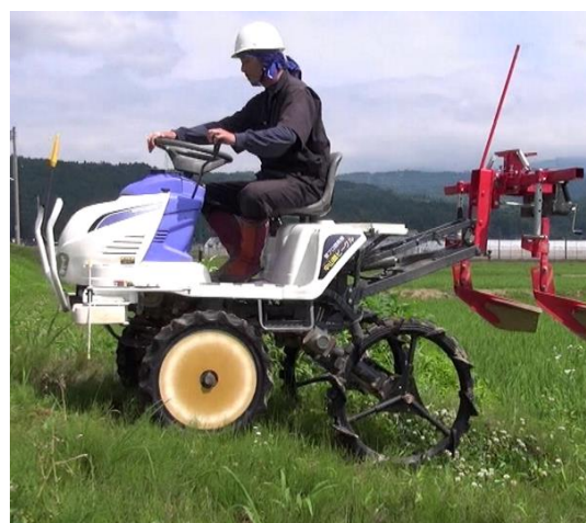
図2 後輪昇降機構を利用した傾斜地走行
