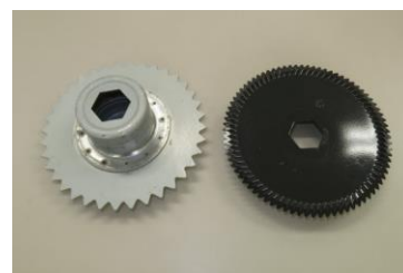
図1 排わらカッタの模式図、ロータ配置間隔、並びにロータ(掻き込みホイール)と回転刃の外観
