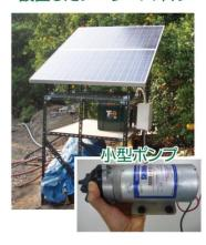
3. 消耗品であるバッテリーとポンプの劣化を抑制してライフサイクルコストを抑えるために、タイマーを用いたポンプの間欠運転(例えば15分運転30分停止など)を行います。
