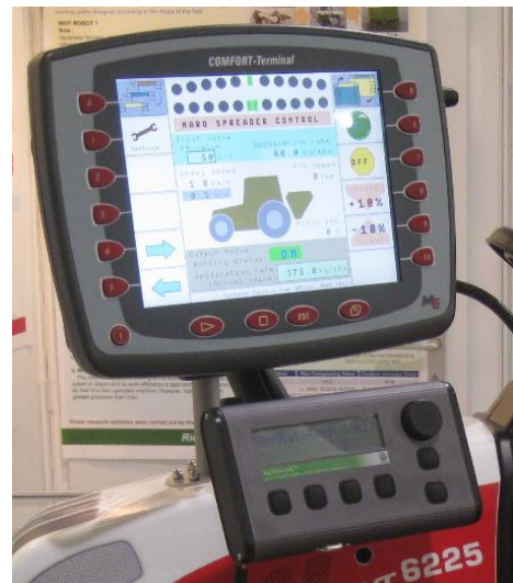
図 1 開発したソフトウェアライブラリを適用した VT（端末）への画面表示例（上）と、共通化リモートコントローラ（下）
