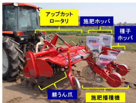
図1. 耕うん同時畝立て播種機 (左). 図2. イタリアンライグラス後におけるトウモロコシ畝立て播種 (中央). 図3. 慣行播種及び畝立て播種されたトウモロコシの乾物収量の比較 (右).
