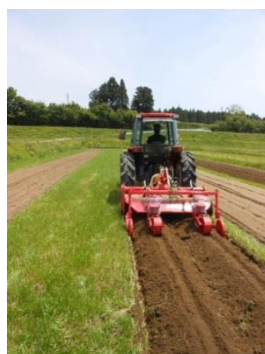
図1. 耕うん同時畝立て播種機 (左). 図2. イタリアンライグラス後におけるトウモロコシ畝立て播種 (中央). 図3. 慣行播種及び畝立て播種されたトウモロコシの乾物収量の比較 (右).
