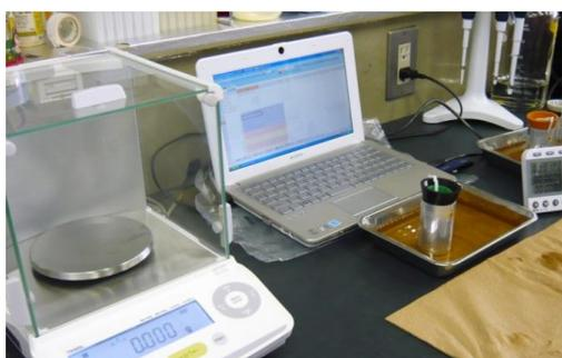
図 1 米粉吸水性評価装置
