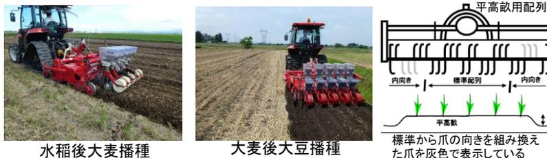
図1 耕うん同時畝立て播種機による平高畝を利用した大麦・大豆栽培
