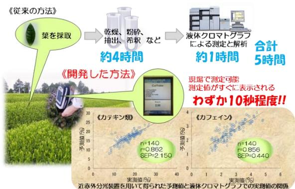
図1 可搬型近赤外分光装置を用いた新しい測定法と従来法との比較
