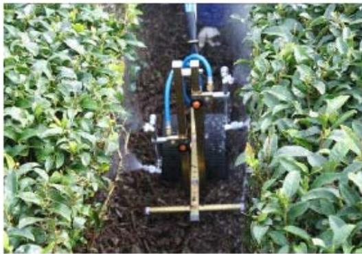
図1 すそ重点専用散布機
