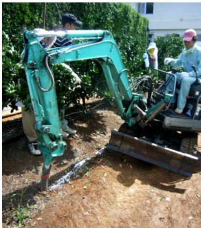
写真 油圧ショベルに装着した断根刃と断根処理作業
