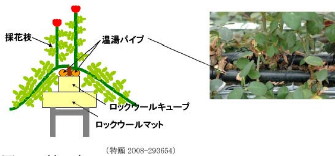
図1 株元加温システムの概要
