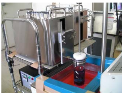
写真1 界面前進凍結濃縮装置
