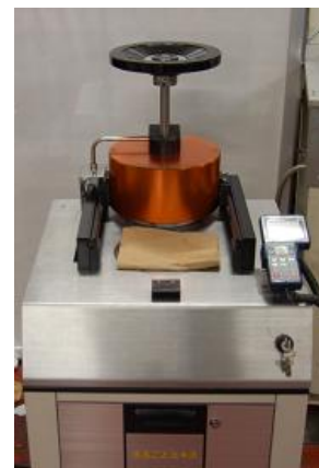
写真2 試験に用いた中高压処理装置
