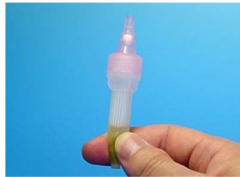
図 2 簡易容器による葉の磨砕
