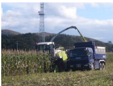
写真1 クラッシャー付コーンハーベスタ(左) 破碎処理とうもろこし(中) 採食状況(右)
