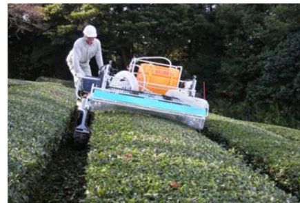
写真 傾斜地に対応した乗用型送風式農薬散布機
