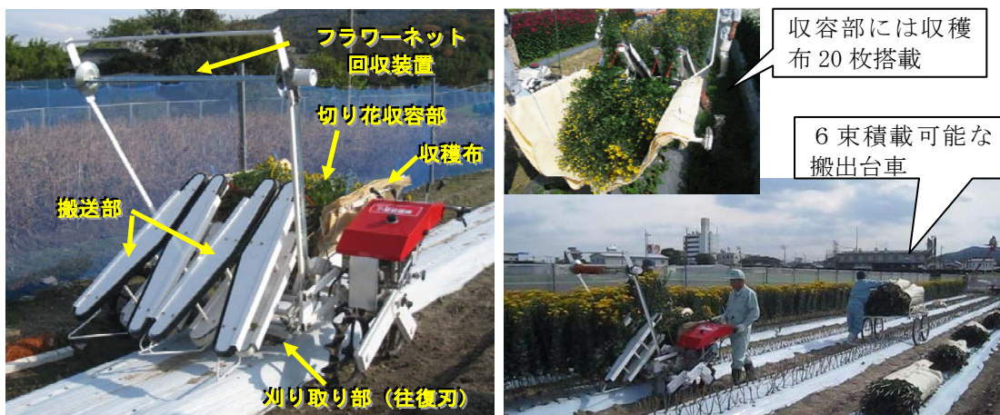
図 小ギク収穫機とこれを利用した収穫作業の様子
