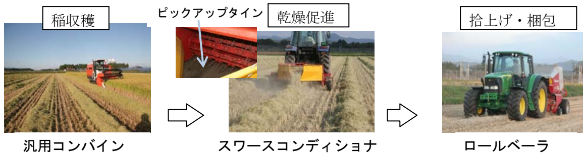
図 汎用コンバインとスワースコンディショナを用いた稲わら収集体系
