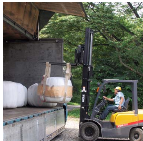
図2. 荷役具とフォークリフトによる、ロールベールの荷役作業
